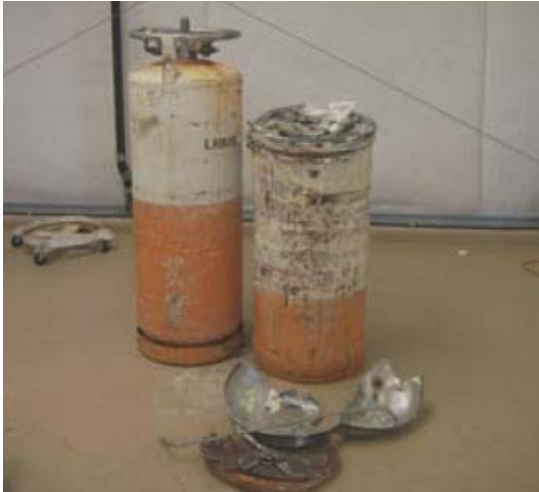
完好的鋼瓶與爆破的鋼瓶殘體
